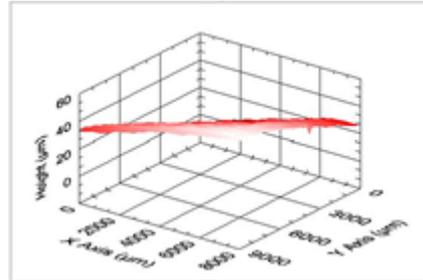
SKP-Oberflächenscan einer lokal mit Wasserstoff beladenen Stahlprobe: links: gemessene Kontaktpotentialdifferenz (CPD), rechts: Topographie aus automatischer Höhenkorrektur
