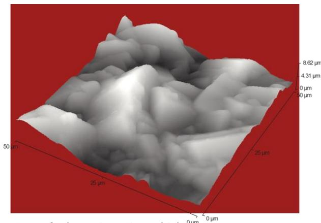
AFM-Aufnahme einer TiB<sub>2</sub>-Schicht
